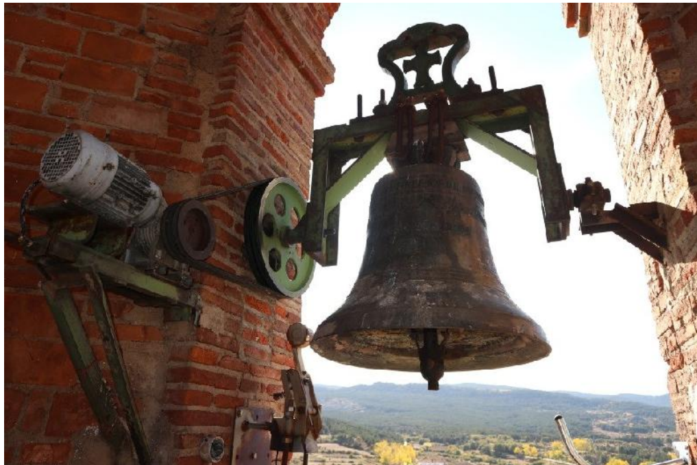
La campana Santa Bárbara de la iglesia parroquial de Orihuela del Tremedal con el yugo de hierro y los mecanismos para el toque automático.
