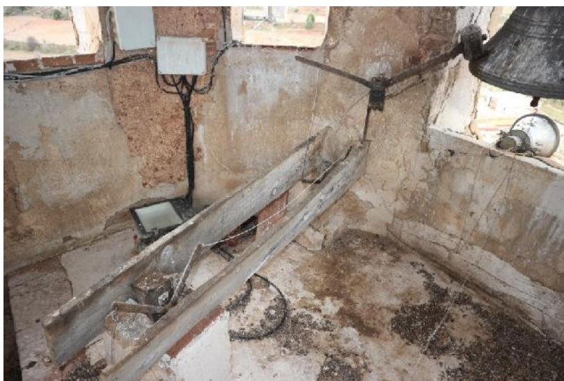
Mazo horario y transmisiones del reloj. Iglesia parroquial de Rubiales
